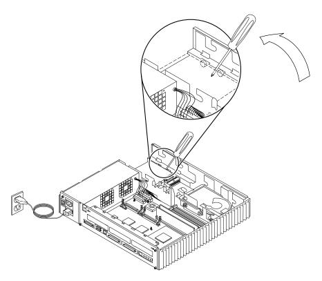
FIGURE 9-9 Disengaging the Diskette Drive
