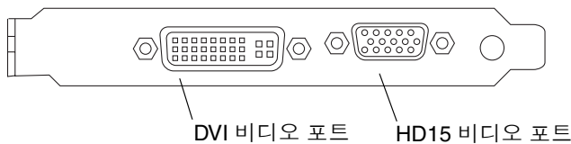
그림 A-1 Sun XVR-100 그래픽 가속기 후면 패널 I/O 포트
