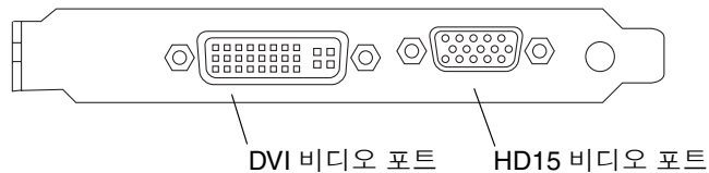
그림 1-2 Sun XVR-100 그래픽 가속기 후면 패널 I/O 포트
