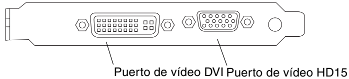
FIGURA 1-2 Puertos de E/S del panel posterior del acelerador de gráficos Sun XVR-100
